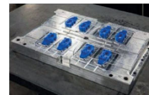
Con l'utensileria multi-cavità, è possibile produrre volumi elevati per far fronte a picchi improvvisi nella domanda.
