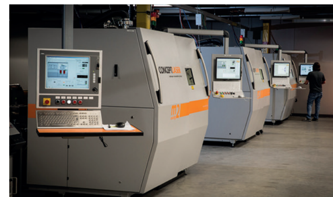
La DMLS può essere usata per creare pezzi complessi in alluminio di difficile lavorazione a macchina.
