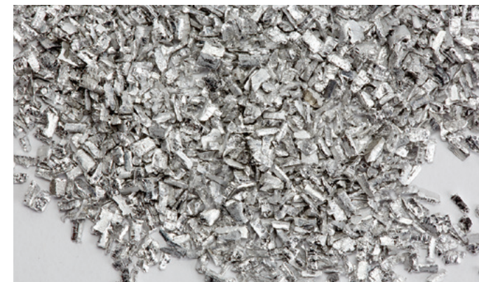
Feedstock usato nello stampaggio a iniezione del magnesio per creare pezzi in magnesio densi al 98%.
