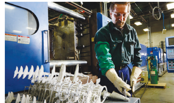
Pezzi in magnesio stampati a iniezione prima della rimozione mediante lavorazione CNC del testimone dei punti di accesso.
